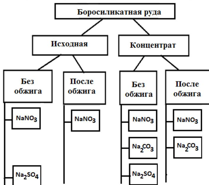
**Рисунок 1** - Схема спекания боросиликатной руды и её концентрата с различными натрийсодержащими реагентами.
