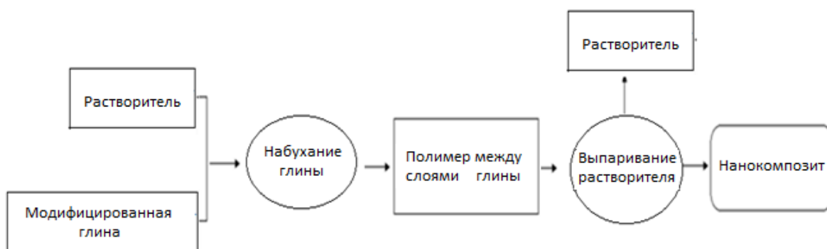
Рисунок 2 - Получения нанокompозита диспергированием в растворе [35].
