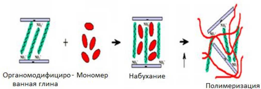
Рисунок 3 - Стадии полимеризации (а) и общий вид (б) in situ [35]
