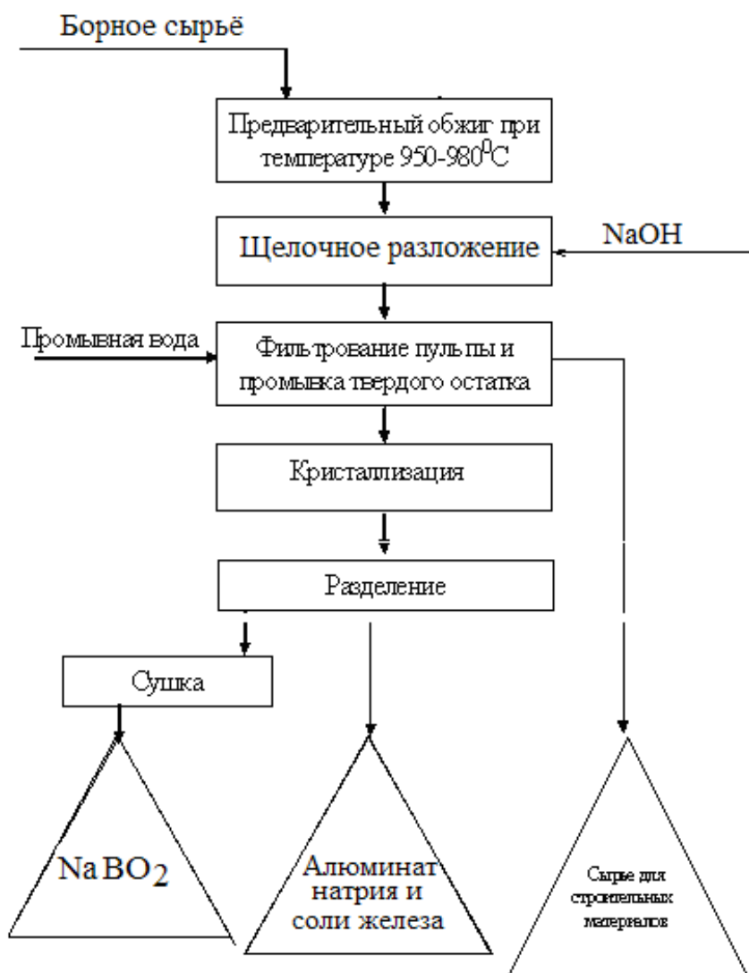
Рисунок 6. Принципиальная технологическая схема переработки борного сырья щелочным способом.
