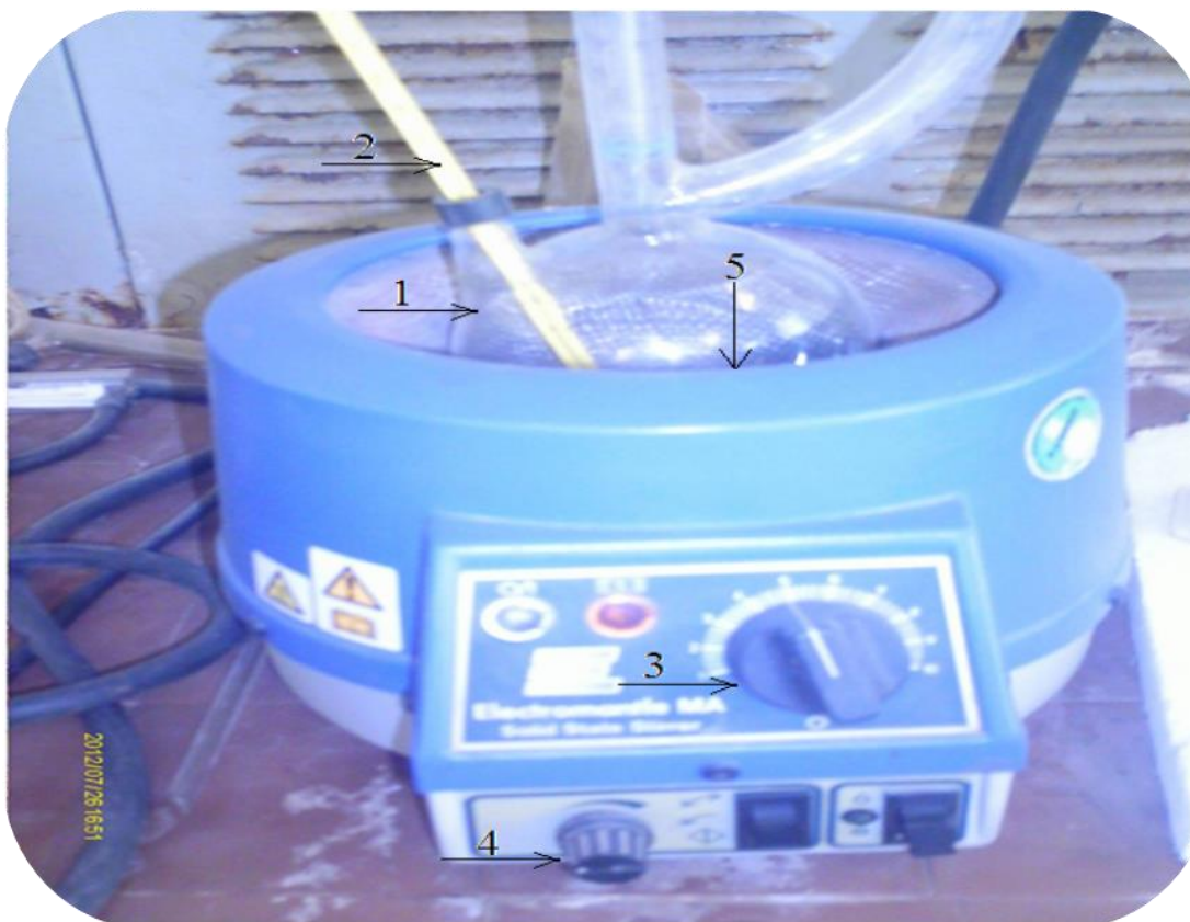
Рисунок 2.4 – Лабораторная установка для изучения процесса разложения флотоконцентрата растворами азотной кислоты.
