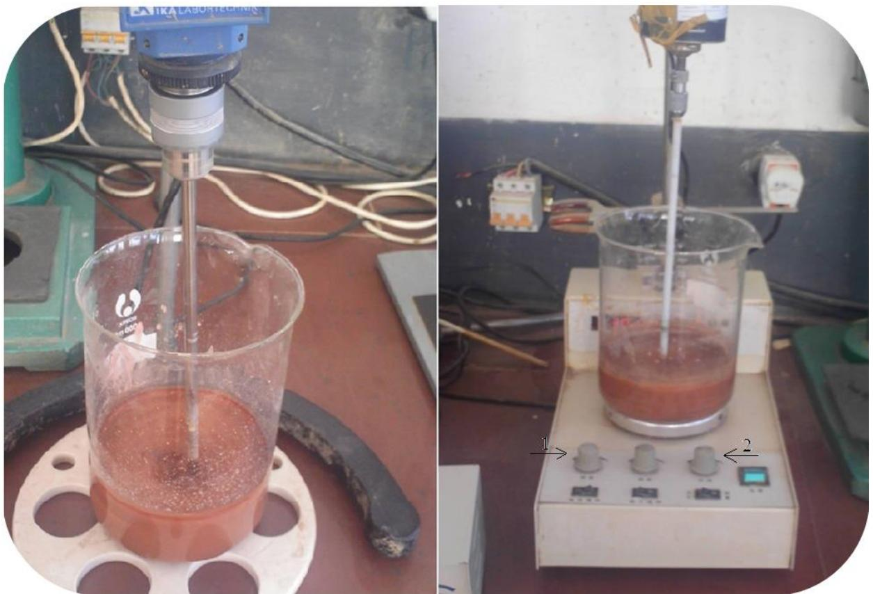
Рисунок 2.22 – Лабораторная установка по изучению процесса тиомочевинного и тиосульфатного выщелачивания золота из руд и концентратов.
