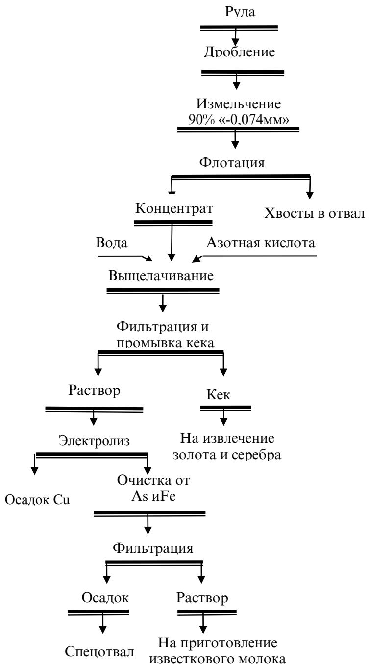
Рисунок 3.18 – Принципиальная технологическая схема переработки золото-, медно-, мышьяксодержащей руды месторождения Тарор.
