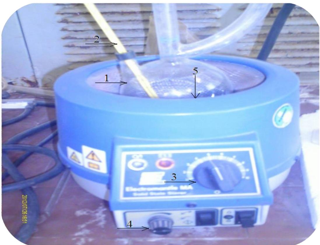
Рисунок 3.10 – Лабораторная установка для изучения процесса разложения флотоконцентрата растворами азотной кислоты.
