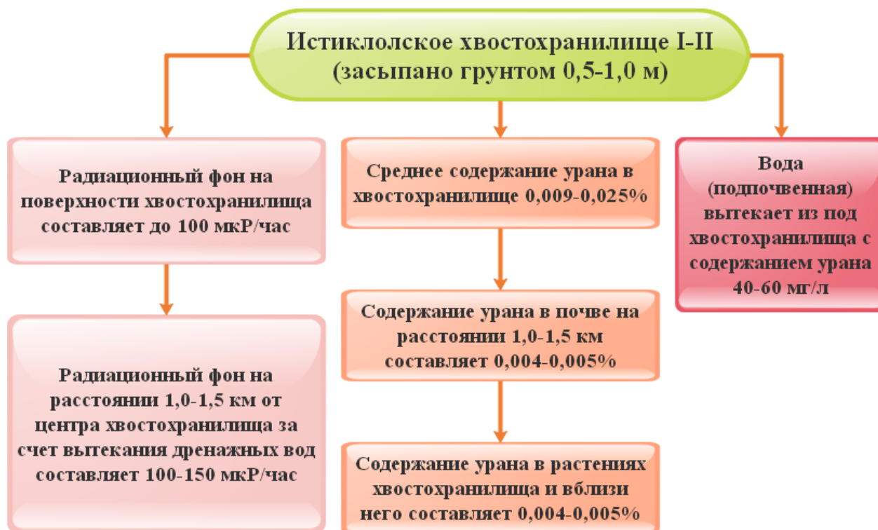
Рисунок 1.4 - Схема хвостохранилища города Истиклол (I-II), согласно данным [4, 19, 20].
