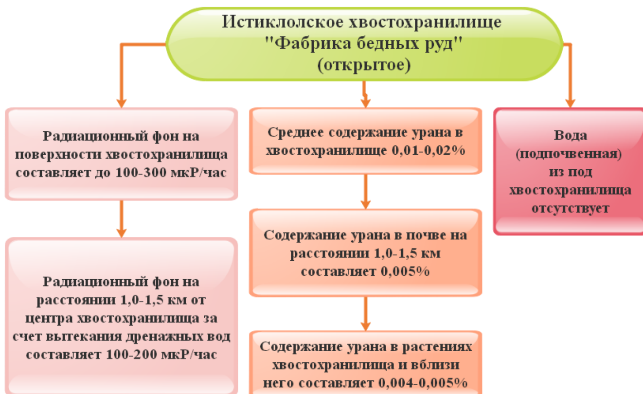
Рисунок 1.8 - Схема хвостохранилища города Истиклол («Фабрика бедных руд»), согласно данным [4, 19].
