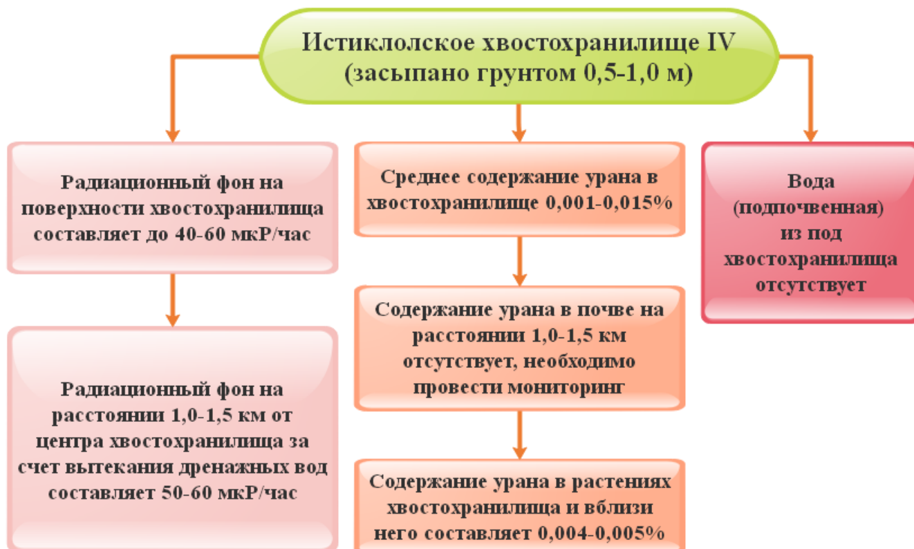
Рисунок 1.6 - Схема хвостохранилища города Истиклол (IV), согласно данным [4, 19, 20].
