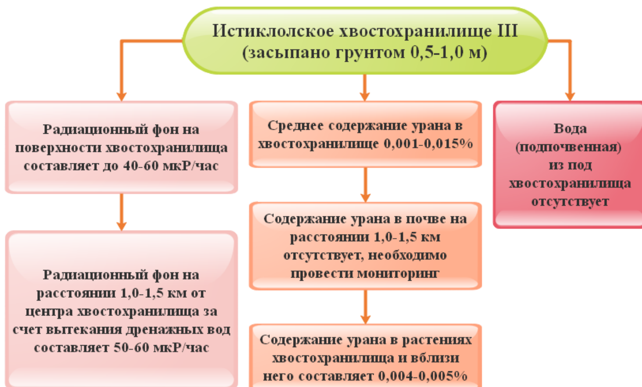
Рисунок 1.5 - Схема хвостохранилища города Истиклол (III), согласно данным [4, 19, 20].
