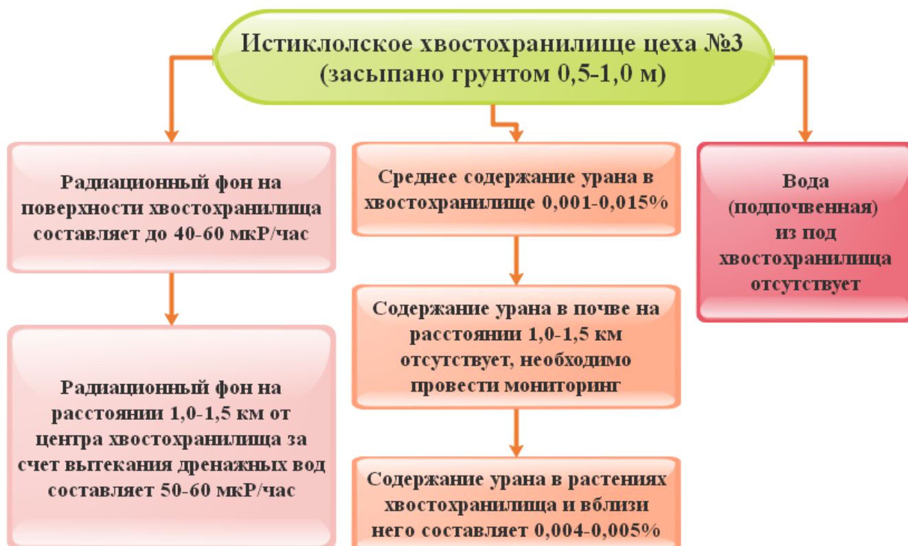
Рисунок 1.7 - Схема хвостохранилища города Истиклол (цех № 3), согласно данным [4, 19].
