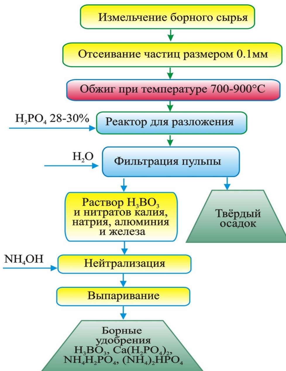
Рисунок 3.11. – Обобщённая упрощённая схема для фосфорнокислотного разложения боросиликатных материалов с получением борных удобрений, соединений кальция и бора
