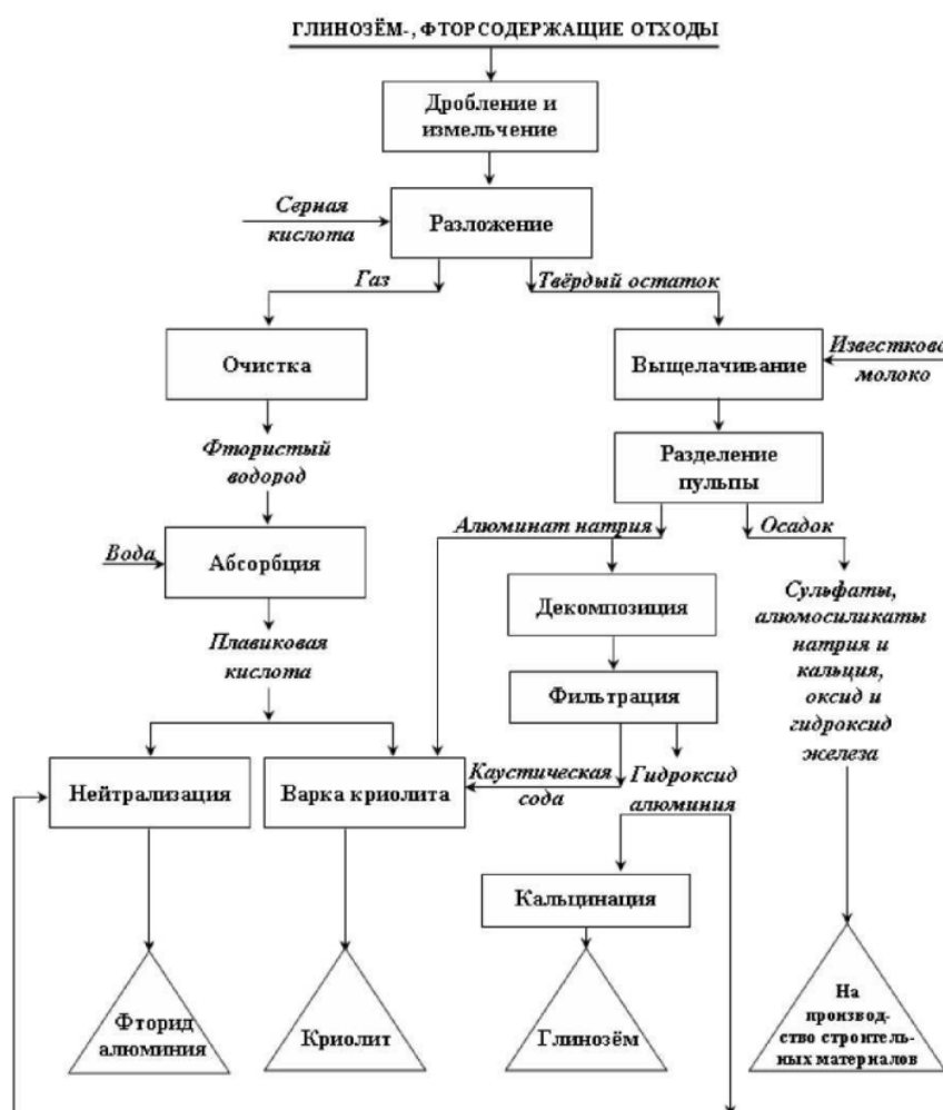
Рисунок 1.5. – Обобщённая технологическая схема по переработке фтор- и глинозёмсодержащих отходов ГУП «ТАЛКО» с получением глинозёма, криолита и фторида алюминия
