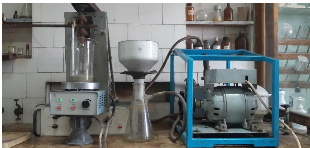
Рисунок 2.2. Схема экспериментальной установки по растворению концентрата в технической фосфорной кислоте
