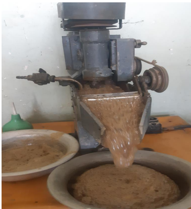
Рисунок 2.1. Машина флотационная ФМЛ 1 (237 ФЛ)
