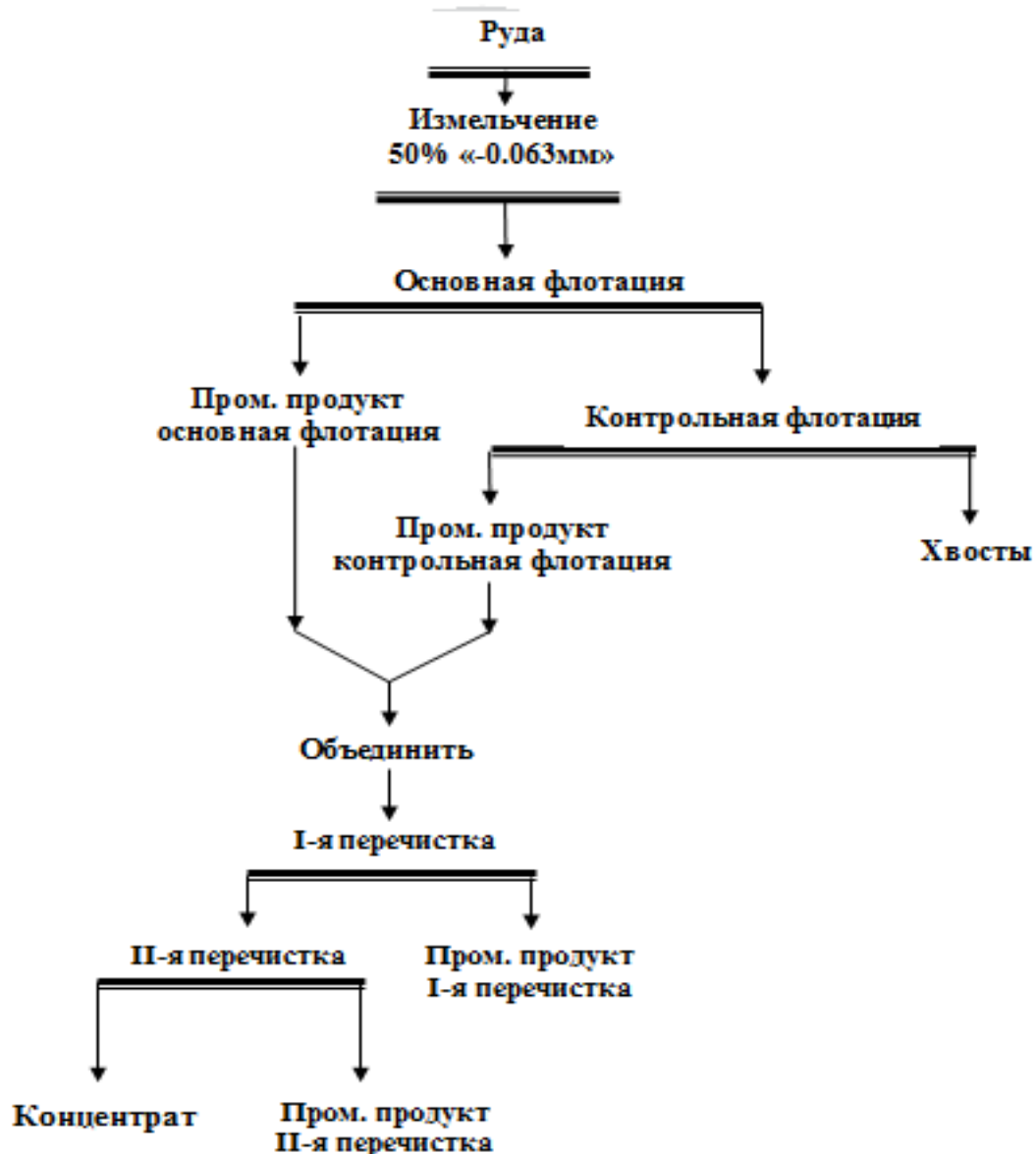
Рисунок 3.2. Технологическая схема флотации фосфоритной руды
