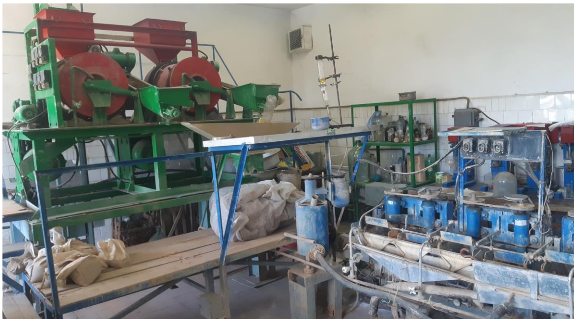
Рисунок 3.14. Полупромышленная установка для обогащения минеральных руд
