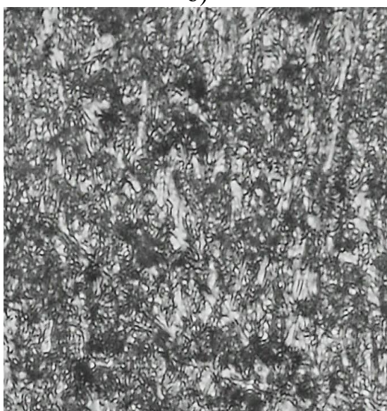
Рисунок 2.5. Микроструктура (x500) сплава \text{AlMg}_{5.5}\text{Li}_{2.1}\text{Zr}_{0.15} (a), и образцов содержащих Se, масс. %: 0,01(б); 0,1(в); 0,5(г); 1,0(д)
