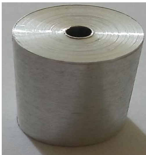
Рисунок 2.10. Образец для исследования методом «охлаждения» из сплава \text{AlMg5.5Li2.1Zr0.15} с лантаном
