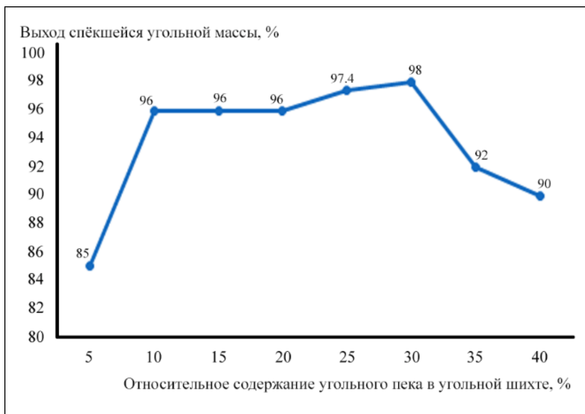
Рисунок 11 - Процент спекшейся шихты, состоящей из угля месторождений «Назар-Айлок» и «Фон Ягноб» в зависимости от содержания в шихте угольного пека.
