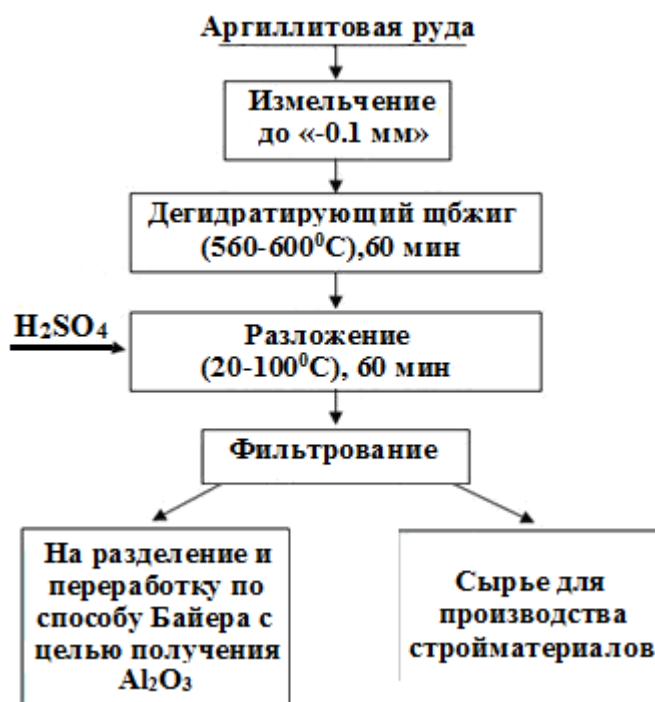
Рисунок 1.5. Схема для комплексного разложения аргиллитовых руд месторождения Чашма-Санг с использованием \text{H}_2\text{SO}_4 .
