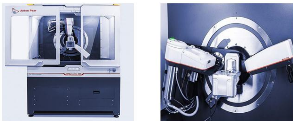
Рисунок 2.2 - Автоматизированный многоцелевой порошковый рентгеновский дифрактометр марки “XRDynamic-500”.
