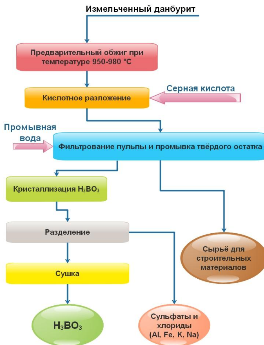
Рисунок 1.5. Базовая технологическая схема извлечения борной кислоты из боросиликатного рудо месторождения Ак-Архар с применением сернокислотного способа.
