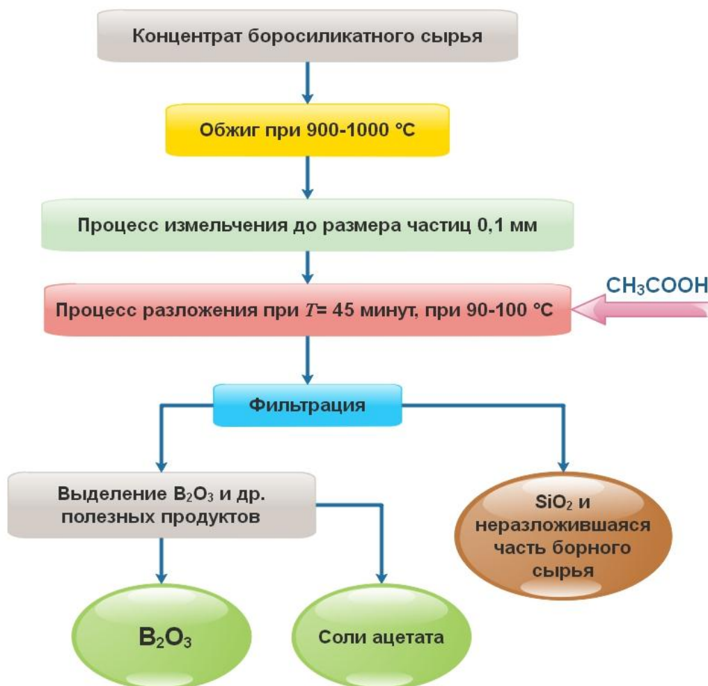
Рисунок 1.15. Базовая технологическая схема выделения полезных материалов при разложении концентрата боросиликатной руды с помощью уксусной кислоты.
