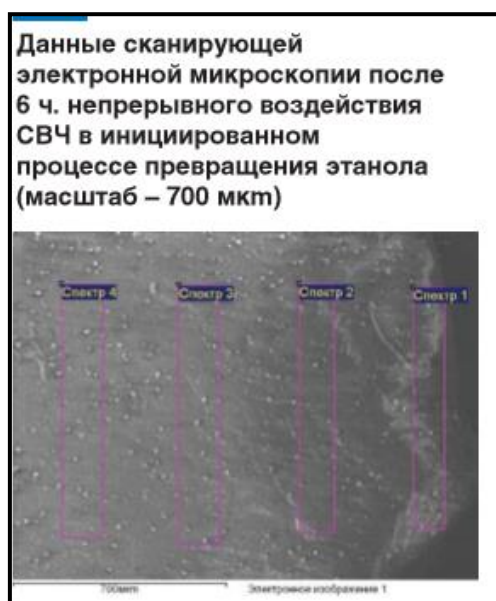
Рисунок 3.22. Сканирующая электронная микроскопия после 6 ч непрерывного воздействия и дифрактограмма \text{ZnO} в \text{Al}_2\text{O}_3
