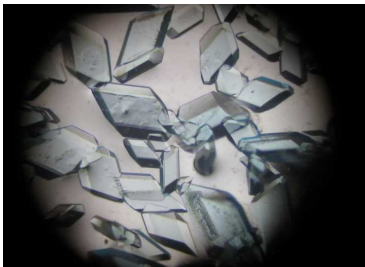
Рисунок 2.15 - Вид кристаллов \text{RbAlH}_4 в поле зрения микроскопа
