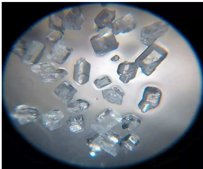
Рисунок 2.16 - Вид кристаллов \text{CsAlH}_4 в поле зрения микроскопа
