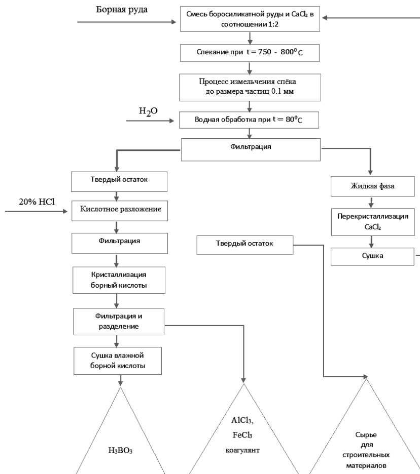
Рисунок 23 – Принципиальная технологическая схема по переработке боросиликатных руд спеканием с хлоридом кальция.
