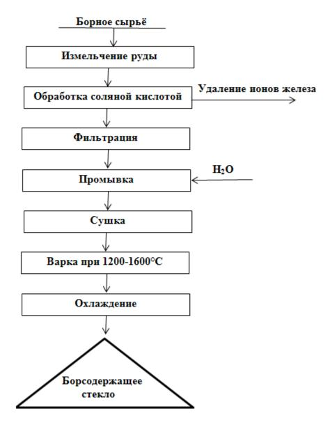
**Рисунок 4.23** — Технологическая схема получения борсодержащего стекла.
