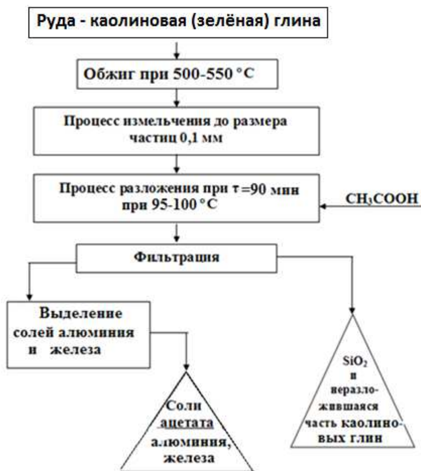
Рисунок 3.4 - Принципиальная технологическая схема получения полезных компонентов из каолинового сырья - зелёной глины разложением уксусной кислотой.
