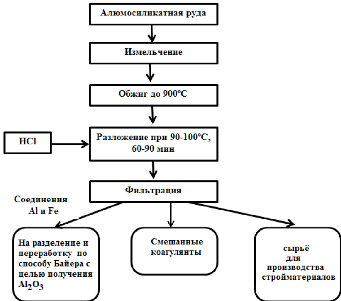
Рисунок 3.18 - Принципиальная технологическая схема переработки алюмосиликатных руд соляной кислотой.
