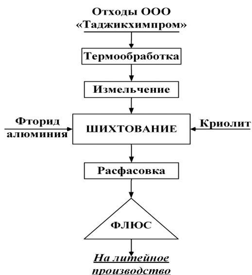
**Рисунок 3** - Принципиальная технологическая схема производства флюса на основе отходов шламовых полей ОАО «Таджикхимпром» с применением фтористых солей
