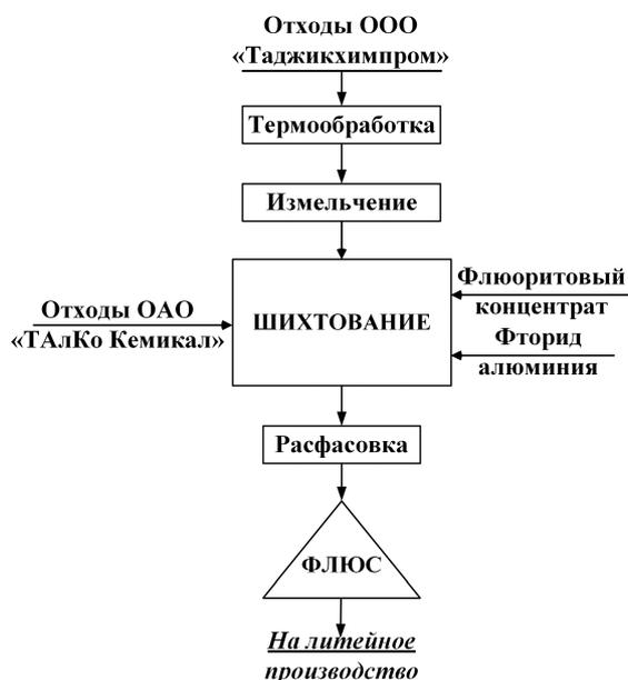
**Рисунок 7** - Принципиальная технологическая схема производства флюса на основе промышленных отходов
