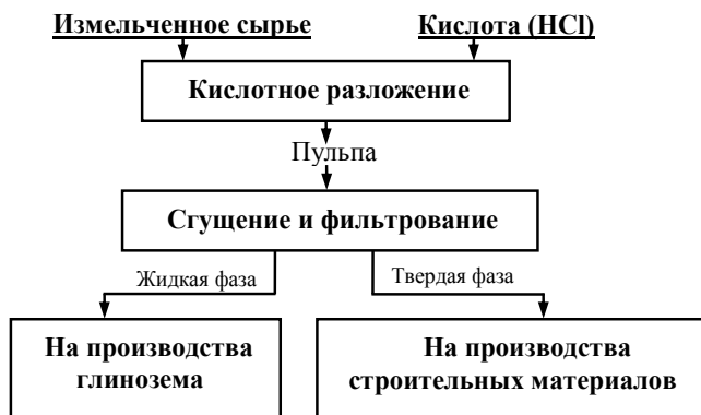
Рис.13. Принципиальная технологическая схема комплексной переработки ставролит-сланцевидных сланцев кислотным методом.
