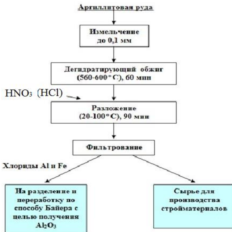
Рисунок 1.3 - Принципиальная технологическая схема комплексной переработки аргиллитов месторождения Чашма-Санг солянокислотным способом.
