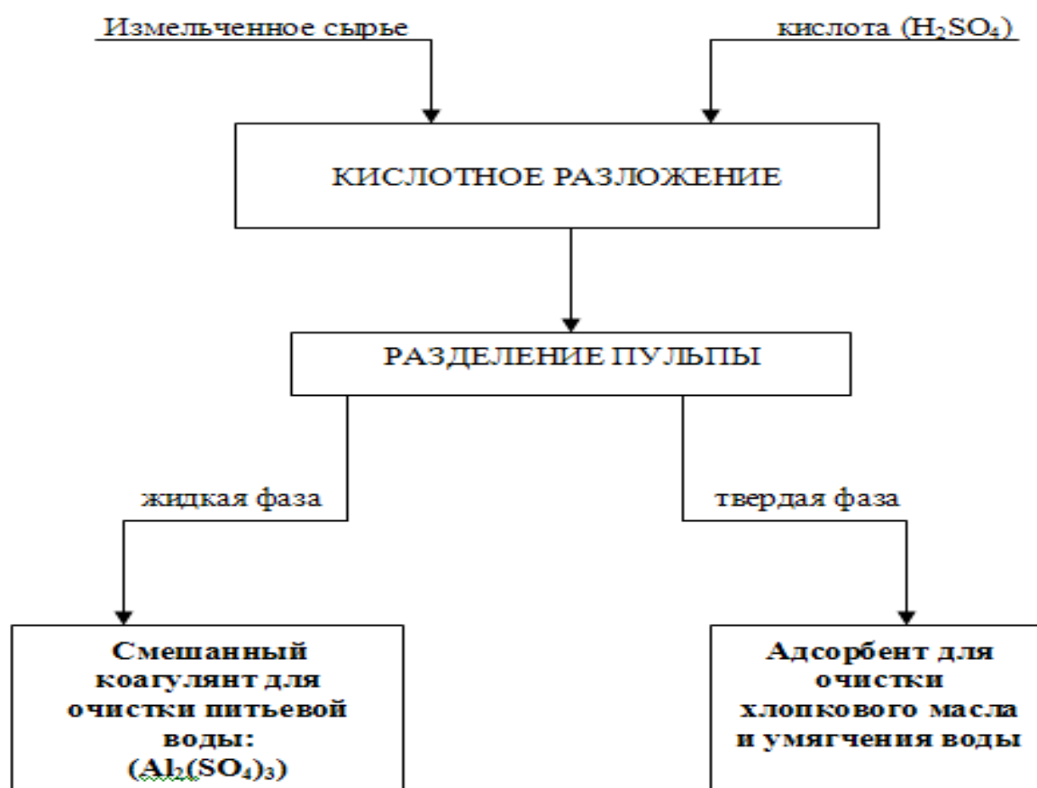
Рисунок 1.9 - Принципиальная технологическая схема переработки бентонитовых глин сернокислотным выщелачиванием.
