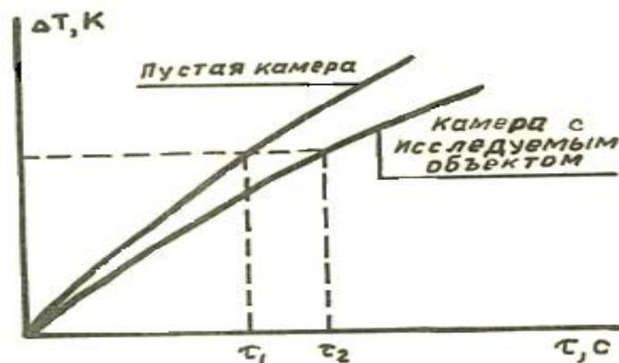
*Рисунок 2.7 - Зависимость повышения температуры измерительной ячейки  $\Delta T$  от времени  $\tau$  [21, 53, 58, 59, 66, 125, 126, 128]*
